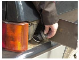
Перед отсоединением топливного и отводящего трубопровода необходимо открыть пробку топливного бака, чтобы удалить возможное внутреннее давление системы.
