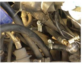
На выпускной штуцер возвратного трубопровода устанавливаем заглушку. Как вариант, ее можно сделать из загнутого и пережатого на конце шланга подходящего размера.
