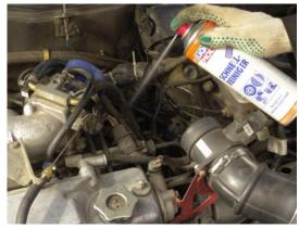
Затем двигатель в районе топливной рампы обрабатывается с помощью специального очистителя. Эта операция необходима для предотвращения попадания в топливную систему пыли с поверхности блока.
