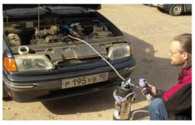
го штуцера возвратного трубопровода можно сделать из загнутого и пережатого на конце шланга подходящего размера.
