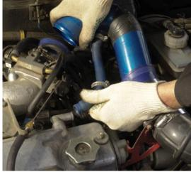
Чтобы облегчить доступ к топливной рампе, временно демонтируем воздуховод.
