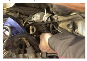
Отсоединяем шланг от впускного и возвратного (в случае если он предусмотрен конструкцией автомобиля) трубопроводов.
