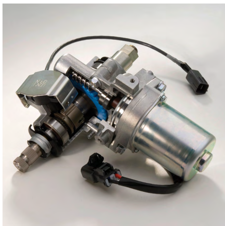
◀ Электроусилитель рулевого управления
