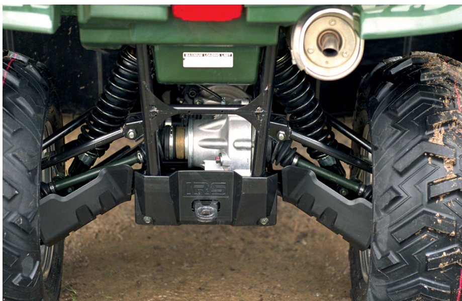
Независимая подвеска задних колес утилитарного квадроцикла
