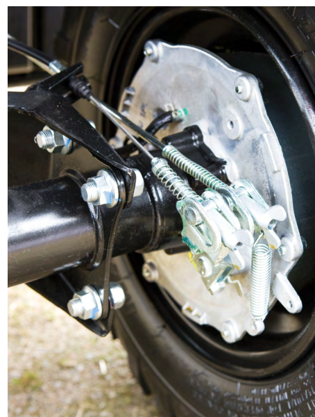
Герметичный тормозной механизм утилитарного квадроцикла с неразрезной осью задних колес
