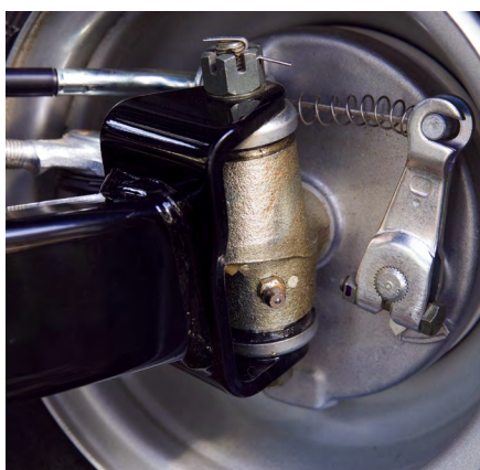
◀ Однорычажная подвеска переднего колеса детского квадроцикла ▶
