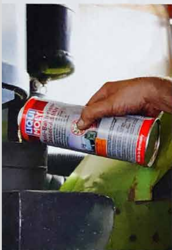
Vorbeugen ist besser als reinigen. Mit der regelmäßigen prophylaktischen Beigabe von speziellen Kraftstoffzusätzen wie dem ‚Anti-Bakterien-Diesel-Additiv‘ von Liqui Moly lässt sich schädliches Mikrobewachstum vermeiden. Davon sind längst nicht nur saisonal benutzte Nutzfahrzeuge oder Wohnmobile mit längeren Standzeiten betroffen. Bild: Kuss
