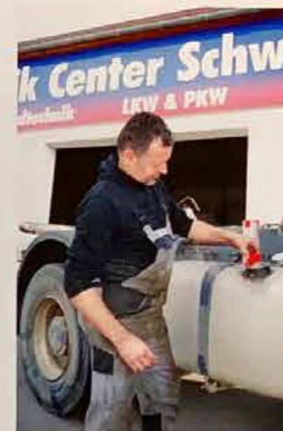
Ist der Tank bereits von der Dieselpest befallen, vernichtet eine problembezogene ‚Schock-Dosierung‘ die Mikroorganismen. Eine regelmäßige prophylaktische Beigabe verhindert zuverlässig einen Neubefall. Bild: Kuss
