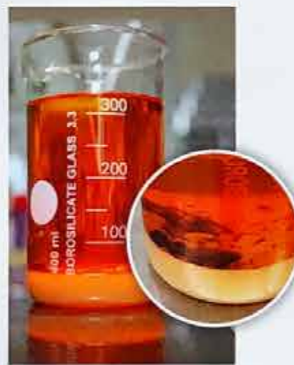
Unter bestimmten Bedingungen können sich Bakterien, Hefen, Pilze und Algen im Dieseltank bilden. Sie ‚fressen‘ und zersetzen den Kraftstoff. Der dabei entstehende Bio-Schlamm verstopft den Kraftstofffilter und die Leitungen. Bild: Liqui Moly
