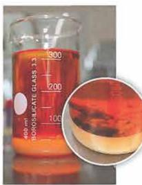
Vorbeugen ist besser als reinigen. Mit der regel-Unter bestimmten Bedingungen können sich Bakterien, Hefen, Pilze und Algen im. Dieseltank bilden. Sie fressen' und zersetzen den Kraftstoff. Der dabei entstehende Bio-Schlamm verstopft den Kraftstofffilter und die Leitungen. Bild: Liqui Moly
