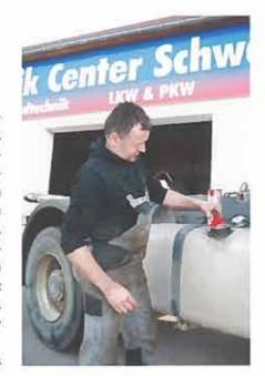
ist der Tank bereits von der Dieselpest befallen, vernichtet eine problembezogene, Schock-Dosierung' die Mikroorganismen. Eine regelmäßige prophylaktische Beigabe verhindert zuverlässig einen Neubefall. Bild: Kuss
